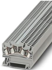
Borne de paso, tensión nominal: 800 V, corriente nominal: 24 A, número de conexiones: 4, tipo de conexión: Conexión por resorte, Sección de dimensionamiento: 2,5 mm<sup>2</sup>, 1er piso, sección: 0,08 mm<sup>2</sup> - 4 mm<sup>2</sup>, clase de montaje: NS 35/7,5, NS 35/15, color: gris
