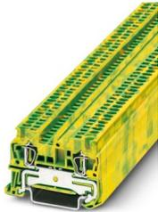
Borne de tierra de conexión por resorte, número de conexiones: 2, tipo de conexión: Conexión por resorte, Sección de dimensionamiento: 1,5 mm<sup>2</sup>, sección: 0,08 mm<sup>2</sup> - 1,5 mm<sup>2</sup>, clase de montaje: NS 35/7,5, NS 35/15, color: amarillo-verde
