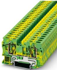
Borna de tierra, número de conexiones: 2, tipo de conexión: Conexión por resorte, Sección de dimensionamiento: 6 mm<sup>2</sup>, sección: 0,2 mm<sup>2</sup> - 10 mm<sup>2</sup>, clase de montaje: NS 35/7,5, NS 35/15, color: amarillo-verde
