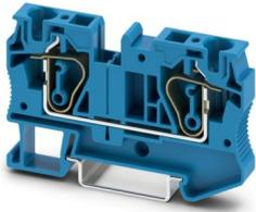
Borne de paso, tensión nominal: 1000 V, corriente nominal: 41 A, número de conexiones: 2, tipo de conexión: Conexión por resorte, Sección de dimensionamiento: 6 mm<sup>2</sup>, sección: 0,2 mm<sup>2</sup> - 10 mm<sup>2</sup>, clase de montaje: NS 35/7,5, NS 35/15, color: azul
