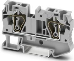
Borne de paso, tensión nominal: 1000 V, corriente nominal: 41 A, número de conexiones: 2, tipo de conexión: Conexión por resorte, Sección de dimensionamiento: 6 mm<sup>2</sup>, sección: 0,2 mm<sup>2</sup> - 10 mm<sup>2</sup>, clase de montaje: NS 35/7,5, NS 35/15, color: gris
