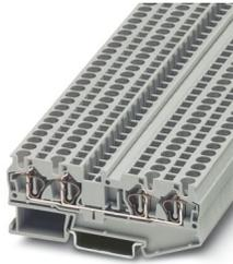
Borne de paso, tensión nominal: 800 V, corriente nominal: 32 A, número de conexiones: 4, tipo de conexión: Conexión por resorte, Sección de dimensionamiento: 4 mm<sup>2</sup>, sección: 0,08 mm<sup>2</sup> - 6 mm<sup>2</sup>, clase de montaje: NS 35/7,5, NS 35/15, color: gris
