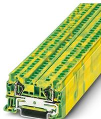
Borne de tierra de conexión por resorte, número de conexiones: 2, tipo de conexión: Conexión por resorte, Sección de dimensionamiento: 4 mm<sup>2</sup>, sección: 0,08 mm<sup>2</sup> - 6 mm<sup>2</sup>, clase de montaje: NS 35/7,5, NS 35/15, color: amarillo-verde
