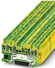
Borna de tierra, número de conexiones: 4, tipo de conexión: Conexión por resorte, Sección de dimensionamiento: 2,5 mm<sup>2</sup>, sección: 0,08 mm<sup>2</sup> - 4 mm<sup>2</sup>, clase de montaje: NS 35/7,5, NS 35/15, color: amarillo-verde
