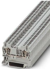
Borne de paso, tensión nominal: 500 V, corriente nominal: 17,5 A, número de conexiones: 2, tipo de conexión: Conexión por resorte, Sección de dimensionamiento: 1,5 mm<sup>2</sup>, 1er piso, sección: 0,08 mm<sup>2</sup> - 1,5 mm<sup>2</sup>, clase de montaje: NS 35/7,5, NS 35/15, color: gris
