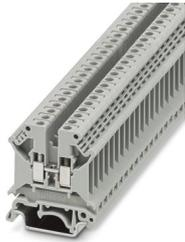
Borne de paso, con hembras roscadas de pruebas a la derecha, para alojar clavijas de prueba, tensión nominal: 500 V, corriente nominal: 32 A, número de conexiones: 2, número de polos: 1, tipo de conexión: Conexión por tornillo, Sección de dimensionamiento: 4 mm<sup>2</sup>, sección: 0,2 mm<sup>2</sup> - 6 mm<sup>2</sup>, clase de montaje: NS 32, NS 35/7,5, NS 35/15, color: gris
