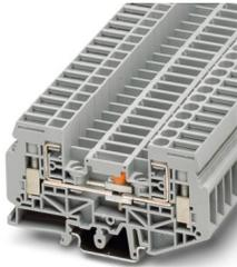
Borne interrump. para circ. medida, tensión nominal: 500 V, corriente nominal: 41 A, tipo de conexión: Conexión por tornillo, 1er piso, Sección de dimensionamiento: 6 mm<sup>2</sup>, sección: 0,5 mm<sup>2</sup> - 10 mm<sup>2</sup>, clase de montaje: NS 35/7,5, NS 35/15, NS 32, color: gris
