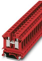
Borne de paso, tensión nominal: 800 V, corriente nominal: 57 A, número de conexiones: 2, número de polos: 1, tipo de conexión: Conexión por tornillo, Sección de dimensionamiento: 10 mm<sup>2</sup>, sección: 0,5 mm<sup>2</sup> - 16 mm<sup>2</sup>, clase de montaje: NS 35/7,5, NS 35/15, color: rojo
