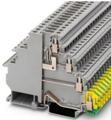
Borne de tierra para distribución, La corriente y la tensión son determinadas por el conector empleado., tensión nominal: 250 V, corriente nominal: 24 A, tipo de conexión: Conexión por tornillo, 2º, 3er, y 4º piso, Sección de dimensionamiento: 2,5 mm<sup>2</sup>, sección: 0,2 mm<sup>2</sup> - 4 mm<sup>2</sup>, tipo de conexión: Conexión por tornillo, Sección de dimensionamiento: 1,5 mm<sup>2</sup>, sección: 0,2 mm<sup>2</sup> - 4 mm<sup>2</sup>, clase de montaje: NS 35/7,5, NS 35/15, color: gris
