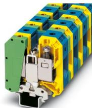
Borne de tierra para distribución, Bloque PE/N, que consta de un borne de tierra verde-amarillo y un borne para carril azul con puente roscado, tensión nominal: 1000 V, corriente nominal: 150 A, Conexión por tornillo, Sección de dimensionamiento: 50 mm<sup>2</sup>, sección: 16 mm<sup>2</sup> - 50 mm<sup>2</sup>, clase de montaje: NS 35/7,5, NS 35/15, NS 32, color: amarillo-verde
