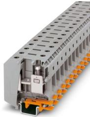
Borne de corriente, tensión nominal: 1000 V, corriente nominal: 150 A, número de conexiones: 2, número de polos: 1, tipo de conexión: Conexión por tornillo, Sección de dimensionamiento: 50 mm<sup>2</sup>, sección: 16 mm<sup>2</sup> - 70 mm<sup>2</sup>, clase de montaje: NS 35/7,5, NS 35/15, NS 32, NS 35/15-2,3, color: gris
