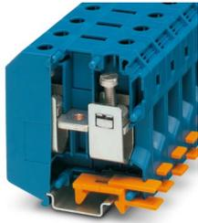
Borne de corriente, tensión nominal: 1000 V, corriente nominal: 150 A, número de conexiones: 2, número de polos: 1, tipo de conexión: Conexión por tornillo, Sección de dimensionamiento: 50 mm<sup>2</sup>, sección: 16 mm<sup>2</sup> - 70 mm<sup>2</sup>, clase de montaje: NS 35/7,5, NS 35/15, NS 32, NS 35/15-2,3, color: azul
