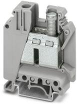
Borne de paso, tensión nominal: 1000 V, corriente nominal: 125 A, número de conexiones: 2, tipo de conexión: Conexión por tornillo, sección: 0,75 mm<sup>2</sup> - 50 mm<sup>2</sup>, clase de montaje: NS 35/7,5, NS 35/15, NS 32, color: gris
