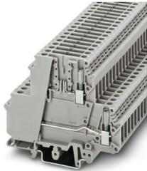
Borna seccionable, La corriente y la tensión son determinadas por el conector empleado., tensión nominal: 400 V, corriente nominal: 26 A, tipo de conexión: Conexión por tornillo, Sección de dimensionamiento: 4 mm<sup>2</sup>, sección: 0,2 mm<sup>2</sup> - 4 mm<sup>2</sup>, 2. Piso, tipo de conexión: Conexión por tornillo, Sección de dimensionamiento: 4 mm<sup>2</sup>, sección: 0,2 mm<sup>2</sup> - 4 mm<sup>2</sup>, montaje: NS 35/7,5, NS 35/15, NS 32, color: gris
