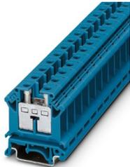
Borna de instalación, tensión nominal: 400 V, corriente nominal: 76 A, Conexión por tornillo, Sección de dimensionamiento: 16 mm<sup>2</sup>, sección: 2,5 mm<sup>2</sup> - 25 mm<sup>2</sup>, clase de montaje: NS 35/7,5, NS 35/15, NS 32, color: azul
