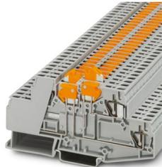
Borna interrumpible por cuchilla, tensión nominal: 400 V, corriente nominal: 16 A, 1er y 2º piso, tipo de conexión: Conexión por resorte, Sección de dimensionamiento: 1,5 mm<sup>2</sup>, sección: 0,2 mm<sup>2</sup> - 4 mm<sup>2</sup>, 2. Piso, tipo de conexión: Conexión por resorte, Sección de dimensionamiento: 1, 5 mm<sup>2</sup>, sección: 0,2 mm<sup>2</sup> - 4 mm<sup>2</sup>, montaje: NS 35/7,5, NS 35/15, color: gris
