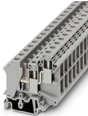
Borne de paso, tensión nominal: 800 V, corriente nominal: 57 A, tipo de conexión: Conexión por tornillo, 1er piso, Sección de dimensionamiento: 10 mm<sup>2</sup>, sección: 0,5 mm<sup>2</sup> - 16 mm<sup>2</sup>, clase de montaje: NS 35/7,5, NS 35/15, NS 32, color: gris
