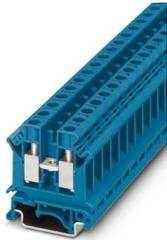
Borne de paso, tensión nominal: 800 V, corriente nominal: 57 A, número de conexiones: 2, tipo de conexión: Conexión por tornillo, Sección de dimensionamiento: 10 mm<sup>2</sup>, sección: 0,5 mm<sup>2</sup> - 16 mm<sup>2</sup>, clase de montaje: NS 35/7,5, NS 35/15, NS 32, color: azul
