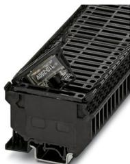
Borne de carril para fusible, tipo de fusible: Vidrio/cerámica/..., tipo de fusible: G/5 x 20/5 x 25/5 x 30, tensión nominal: 250 V, corriente nominal: 6,3 A, número de polos: 1, tipo de conexión: Conexión por tornillo, Sección de dimensionamiento: 4 mm<sup>2</sup>, sección: 0,2 mm<sup>2</sup>- 4 mm<sup>2</sup>, clase de montaje: NS 35/7,5, NS 35/15, NS 32, color: negro
