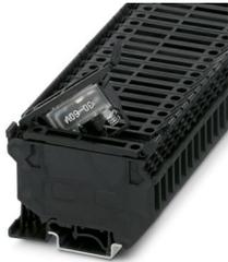
Borne de carril para fusible, tipo de fusible: Vidrio/cerámica/..., tipo de fusible: G/5 x 20, tensión nominal: 60 V, corriente nominal: 6,3 A, tipo de conexión: Conexión por tornillo, Sección de dimensionamiento: 4 mm<sup>2</sup>, sección: 0,2 mm<sup>2</sup>- 4 mm<sup>2</sup>, clase de montaje: NS 35/7,5, NS 35/15, NS 32, color: negro
