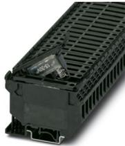
Borne de carril para fusible, tipo de fusible: Vidrio/cerámica/..., tipo de fusible: G/5 x 20/5 x 25/5 x 30, tensión nominal: 24 V, corriente nominal: 6,3 A, número de polos: 1, tipo de conexión: Conexión por tornillo, Sección de dimensionamiento: 4 mm<sup>2</sup>, sección: 0,2 mm<sup>2</sup>- 4 mm<sup>2</sup>, clase de montaje: NS 35/7,5, NS 35/15, NS 32, color: negro
