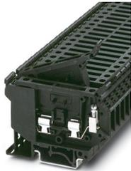
Borne de carril para fusible, tipo de fusible: Vidrio/cerámica/..., tipo de fusible: G/5 x 20/5 x 25/5 x 30, tensión nominal: 800 V, corriente nominal: 6,3 A, número de polos: 1, tipo de conexión: Conexión por tornillo, Sección de dimensionamiento: 4 mm<sup>2</sup>, sección: 0,2 mm<sup>2</sup>- 4 mm<sup>2</sup>, clase de montaje: NS 35/7,5, NS 35/15, NS 32, color: negro
