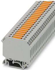
Borna interrumpible por cuchilla, con hembras roscadas para tomas de prueba para alojar clavijas de prueba, tensión nominal: 500 V, corriente nominal: 16 A, 1er piso, tipo de conexión: Conexión por tornillo, Sección de dimensionamiento: 2,5 mm<sup>2</sup>, sección: 0,2 mm<sup>2</sup> - 6 mm<sup>2</sup>, montaje: NS 35/7,5, NS 35/15, NS 32, color: gris
