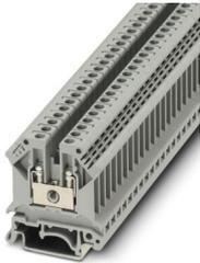
Borne de paso, tensión nominal: 800 V, corriente nominal: 32 A, número de conexiones: 2, tipo de conexión: Conexión por tornillo, sección: 0,2 mm<sup>2</sup> - 4 mm<sup>2</sup>, clase de montaje: NS 35/7,5, NS 35/15, NS 32, color: gris
