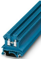
Borne de paso, tensión nominal: 800 V, corriente nominal: 24 A, número de conexiones: 2, tipo de conexión: Conexión por tornillo, Sección de dimensionamiento: 2,5 mm<sup>2</sup>, sección: 0,2 mm<sup>2</sup> - 4 mm<sup>2</sup>, clase de montaje: NS 35/7,5, NS 35/15, NS 32, color: azul
