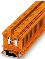
Borne de paso, tensión nominal: 800 V, corriente nominal: 32 A, número de conexiones: 2, tipo de conexión: Conexión por tornillo, Sección de dimensionamiento: 4 mm<sup>2</sup>, sección: 0,2 mm<sup>2</sup> - 6 mm<sup>2</sup>, clase de montaje: NS 35/7,5, NS 35/15, NS 32, color: naranja
