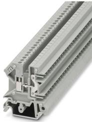
Borne de paso, tensión nominal: 250 V, corriente nominal: 12 A, número de conexiones: 3, número de polos: 1, tipo de conexión: Conexión por tornillo / conexión enchufable, 2º piso, conexión a la izquierda, sección: 0,2 mm<sup>2</sup> - 4 mm<sup>2</sup>, clase de montaje: NS 32, NS 35/15, NS 35/7,5, color: gris
