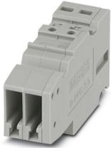
Acoplamiento COMBI, tensión nominal: 500 V, corriente nominal: 24 A, número de conexiones: 2, número de polos: 2, tipo de conexión: Conexión push-in, Sección de dimensionamiento: 2,5 mm<sup>2</sup>, 1er piso, sección: 0,14 mm<sup>2</sup> - 4 mm<sup>2</sup>, color: gris
