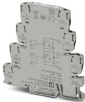
PLC-INTERFACE con dos relés independientes, compuesto de borne de base PLC-BSC.../21 con conexión por tornillo y dos relés integrados, contacto de potencia, para el montaje sobre carril NS 35/7,5, 2 x 1 contacto de cierre, tensión de entrada 24 V DC
