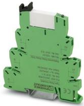
PLC-INTERFACE para aplicaciones ferroviarias, compuesto de borne de base con conexión por resorte y relé en miniatura enchufable con contacto de oro multicapa, rango:  $0,7 \times U_N$  hasta  $1,25 \times U_N$ , clase de temperatura TX:  $-40 \text{ }^\circ\text{C}$  hasta  $+70 \text{ }^\circ\text{C}$ , 1 contacto conmutado, tensión de entrada 24 V DC
