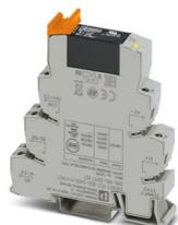
PLC-INTERFACE para funciones de salida, compuesto de borne de base PLC-BSC.../ACT con conexión por tornillo y relé de estado sólido en miniatura enchufable, para el montaje sobre carril NS 35/7,5, 1 contacto de cierre, entrada: 24 V DC, salida: 24-253 V AC/2 A
