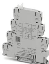
PLC-INTERFACE para aplicaciones NAMUR, compuesto de borna de base PLC-BSC.../21 con conexión por tornillo y circuito integrado, para el montaje sobre carril DIN NS 35/7,5, salida con conmutación positiva, tensión de alimentación de 24 V DC
