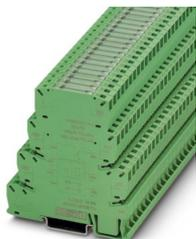
PLC-INTERFACE para aplicaciones NAMUR, compuesto de borne de base PLC-BSP.../21 con conexión por resorte y circuito integrado, para el montaje sobre carril NS 35/7,5, con conmutación negativa, 1 contacto de cierre, tensión de entrada 24 V DC
