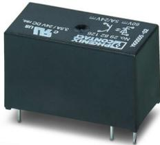
Relé de estado sólido en miniatura enchufable, relé de estado sólido de potencia, 1 contacto de cierre, entrada: 60 V DC, salida: 3-33 V DC/5 A
