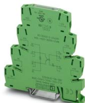
PLC-INTERFACE para aplicaciones ferroviarias, compuesto de borne de base con conexión por tornillo y relé de estado sólido en miniatura integrado, rango:  $0,7 \times U_N$  hasta  $1,25 \times U_N$ , rango de temperatura:  $-25 \text{ °C}$  hasta  $+70 \text{ °C}$ , 1 contacto de cierre, entrada: 110 V DC, salida: 3-33 V DC/3 A
