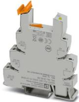
Borna de base PLC de 14 mm contra corrientes parásitas o tensiones parásitas en el lado de control con conexión por tornillo, sin equipamiento de relé o relé de estado sólido, para montar sobre carril DIN NS 35/7,5, con filtro RC integrado, 2 conmutadores, tensión de entrada de 120 V AC
