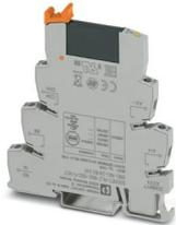
PLC-INTERFACE para funciones de salida, compuesto de borne de base PLC-BSC.../ACT con conexión por tornillo y relé de estado sólido en miniatura enchufable, para el montaje sobre carril NS 35/7,5, 1 contacto de cierre, entrada: 5 V DC, salida: 3-33 V DC/3 A
