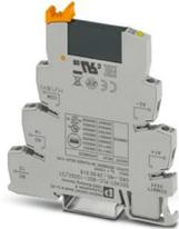
PLC-INTERFACE, compuesto de borne de base PLC-BSC.../21 con conexión por tornillo y relé de estado sólido en miniatura enchufable, para el montaje sobre carril NS 35/7,5, 1 contacto de cierre, tensión de entrada: 125 V DC, salida: 24-253 V AC/0,75 A
