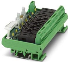
Módulo de salidas VARIOFACE, con zócalos enchufables para 8 relés de miniatura, con 1 contacto conmutado cada uno, para 24 V DC (sin relés)
