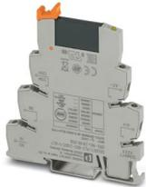
PLC-INTERFACE para funciones de salida, compuesto de borne de base PLC-BSC.../ACT con conexión por tornillo y relé de estado sólido en miniatura enchufable, para el montaje sobre carril NS 35/7,5, 1 contacto de cierre, entrada: 24 V DC, salida: 24 ... 253 V AC/0,75 A
