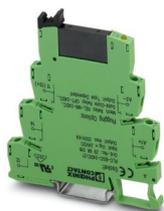
PLC-INTERFACE, compuesto de borne de base PLC-BSP.../21 con conexión por resorte y relé de estado sólido en miniatura enchufable, para el montaje sobre carril NS 35/7,5, 1 contacto de cierre, entrada: 60 V DC, salida: 24 ... 253 V AC/ 0,75 A
