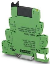
PLC-INTERFACE, compuesto de borne de base PLC-BSP.../21 con conexión por resorte y relé de estado sólido en miniatura enchufable, para el montaje sobre carril NS 35/7,5, 1 contacto de cierre, entrada: 60 V DC, salida: 3-33 V DC/3 A
