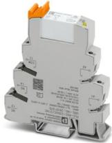
PLC-INTERFACE, compuesto de borne de base PLC-BSC.../21 con conexión por tornillo y relé en miniatura enchufable para corrientes constantes elevadas, para montar sobre carril NS 35/7,5, corriente constante límite hasta 10 A, 1 contacto conmutado, tensión de entrada 230 V AC/ 220 V DC
