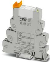
Interfaz PLC, compuesta por borne de base PLC-BSC.../21 con conexión por tornillo y relé miniatura enchufable con contacto de potencia, para el montaje sobre carril NS 35/7,5, 2 contactos conmutados, tensión de entrada 24 V DC
