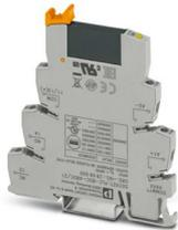
PLC-INTERFACE, compuesto de borne de base PLC-BSC.../21 con conexión por tornillo y relé de estado sólido en miniatura enchufable, para el montaje en carril NS 35/7,5, 1 contacto de cierre, entrada: 48 V DC, salida: 3-48 V DC/100 mA
