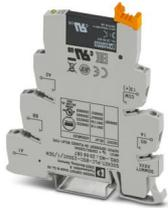
PLC-INTERFACE para funciones de entrada, compuesto de borne de base PLC-BSC.../SEN con conexión por tornillo y relé de estado sólido en miniatura enchufable, para el montaje sobre carril NS 35/7,5, 1 contacto de cierre, entrada: 230 V AC/220 V DC, salida: 3-48 V DC/100 mA
